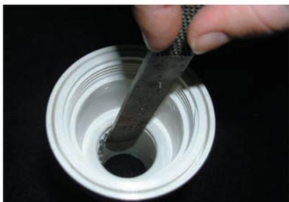
Si existe suciedad o restos de cola o PVC use una cuchilla o una lima para limpiar los restos hasta que el impulsor pueda pasar libremente.
